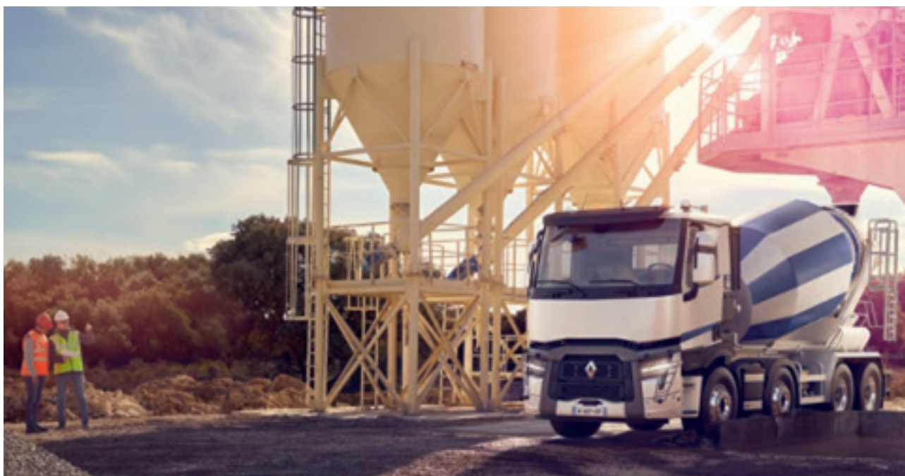
Betoniarka C XLOAD 8x4 na podwoziu ciężarowym o masie własnej 9 200 kg.
