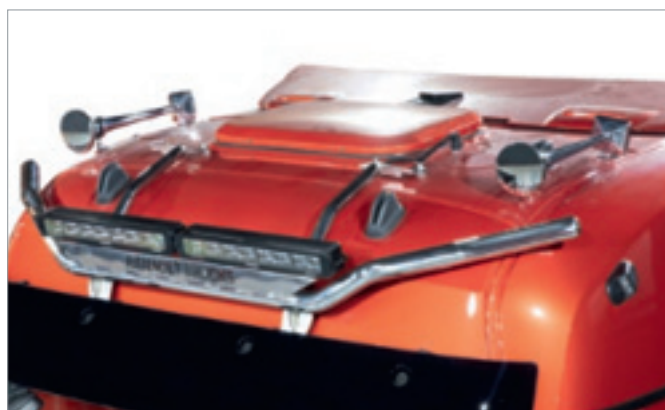
Belka dachowa z dwoma modułami LED
