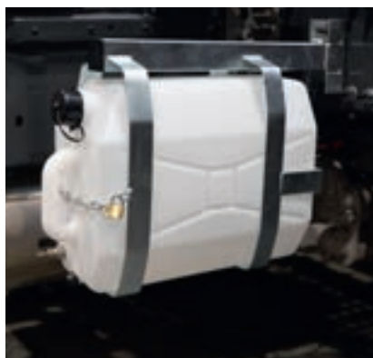
Zbiornik z wodą
