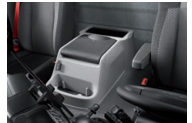
SCHÓWEK NA TUNELU SILNIKA 15 l pojemności, stolik do pisania, uchwyty na butelki, uchwyty na kubki, zasilanie dodatkowe 24 V.
