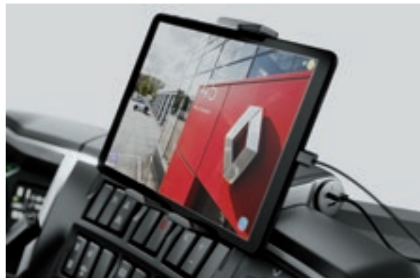
UCHWYT NA TABLET z 2 gniazdami typu USB-C.
