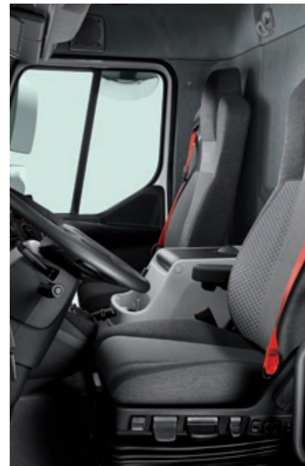
KOMFORTOWE FOTELE z pneumatycznym zawieszeniem, z regulowanym podparciem bocznym i lędźwiowym oraz podgrzewaniem.
